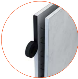
d'un joint compressible à l'avancement lors de la pose ;
