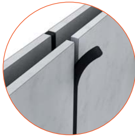
d'un cordon de mousse bourré avec la pose ;
