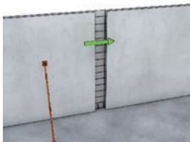
4 Ripage des armatures de liaison dans le prémur 2.
