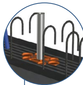
A. DAK poutre pour Tube garde-corps Espacement : 2 m maxi entre les tubes Tolérance de verticalité à \pm 5^\circ
